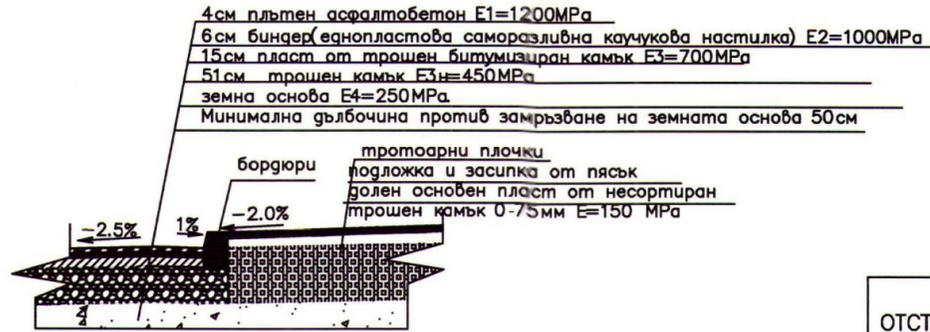
ТИПОВ НАПРЕЧЕН ПРОФИЛ
